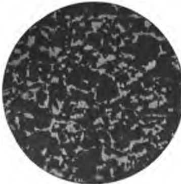
Fig. 13. Pearlite, 60 Per Cent; Carbon, 0.54 Per Cent
